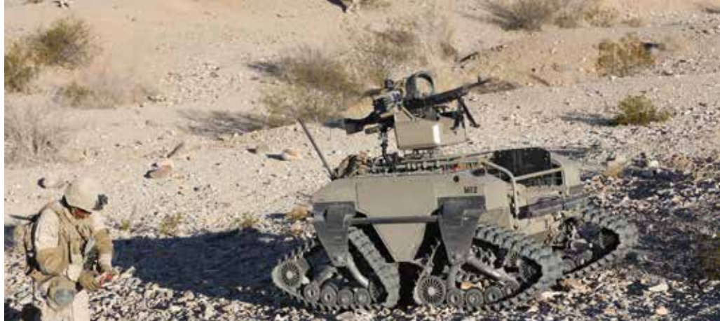
MUTT existuje také v ozbrojené verzi W-MUTT vybavené pásovým podvozkem.
