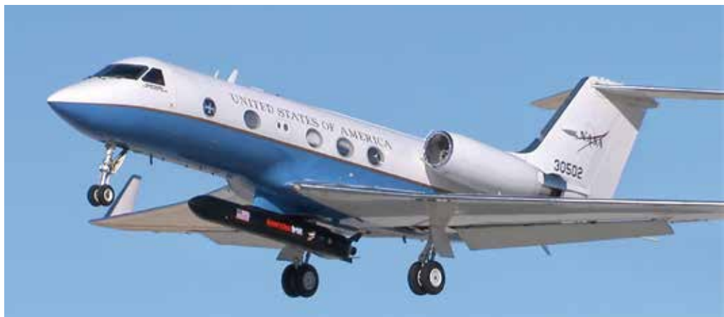
K trojici „vývozních“ letů demonstrátoru GO1-ITA byl využit stroj Gulfstream C-20A z flotily NASA. K této úloze se hodí především proto, že disponuje podtrupovým závěsníkem s nosností až 544 kg.
