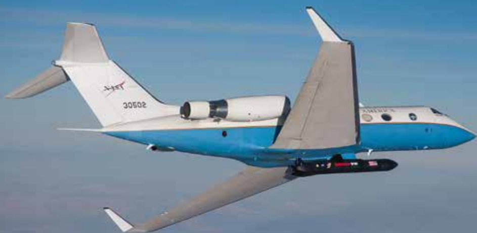
Typ X-60A má umožňovat suborbitální kosmické lety až do výšky 300 km s nákladem v rozmezí 9–90 kg. Při hypersonickém letovém profilu se u něj plánuje nosnost až 318 kg.
