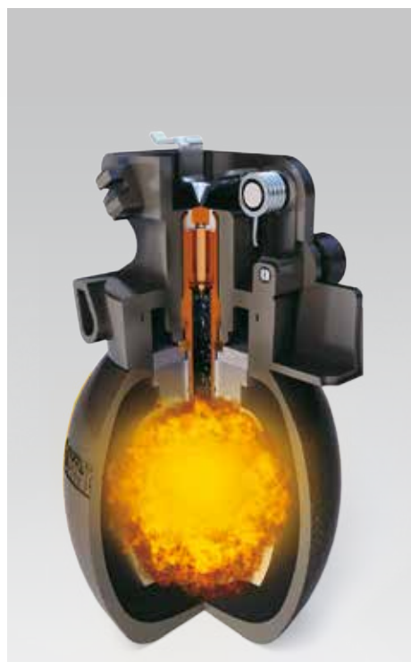
Prohoření zpožďovače, iniciace rozbušky – počínové (účinné) náplně, výbuch granátu
