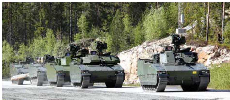
Na tomto snímku lze dobře porovnat původní siluetu věže (na stroji v popředí) s věží osazenou přídatným modulárním pancéřováním (na průzkumné variantě CV9030N Mk.III vzadu)
