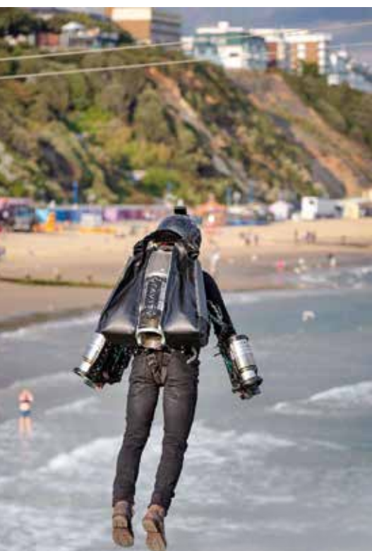
Všech pět pohonných jednotek Gravity Jet Suitu má kombinovaný výkon 783 kW a tah o síle 1,4 kN.
