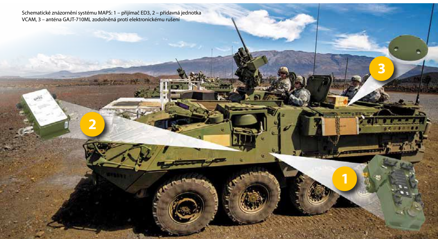
Příslušník 2. jízdního pluku US Army manipuluje s anténou GAJT-710ML disponující sedmi aktivními anténními prvky. Tyto elementy dokážou generovat signál, který je opačný k signálu rušiče, čímž anulují jeho vliv.
