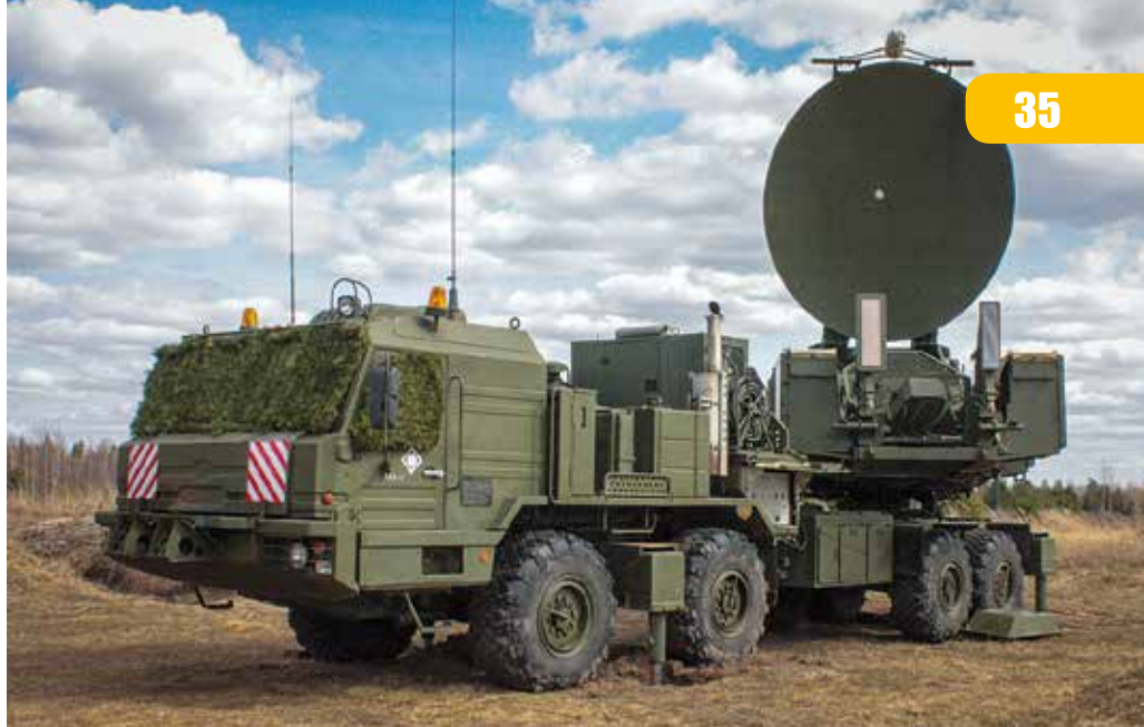
Komplety EB 1RL257 Krasucha-4 (nahoře) a 1L269 Krasucha-2 začala ruská armáda zařazovat do služby v roce 2012. Po zapojení do konfliktu na východě Ukrajiny a v Sýrii se měly tyto systémy, údajně spolehlivě rušící signál GPS, intenzivně používat v obou regionech.
