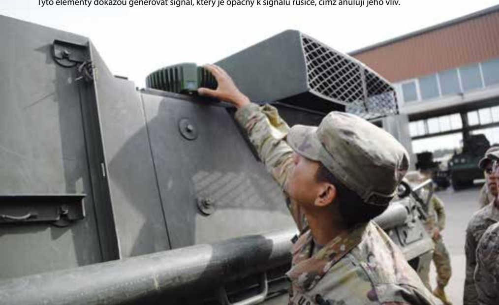
Příslušník 2. jízdního pluku US Army manipuluje s anténou GAJT-710ML disponující sedmi aktivními anténními prvky. Tyto elementy dokážou generovat signál, který je opačný k signálu rušiče, čímž anulují jeho vliv.
