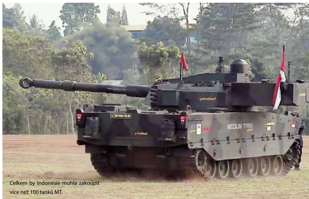
MT během dynamických zkoušek s dobře patrným zaměřovačem střelce a 7,62mm spřaženým kulometem vpravo od kanonu.
