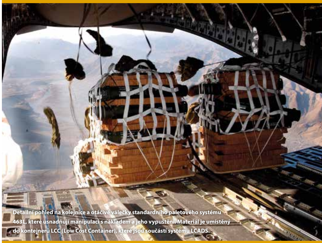
Často používaným způsobem balení materiálu je souprava CDS, jež sestává z textilního kontejneru A-22 a překližkové palety. Pro manipulaci a ukotvení v nákladovém prostoru se CDS zasouvá do kolejnic paletového systému 463L.
