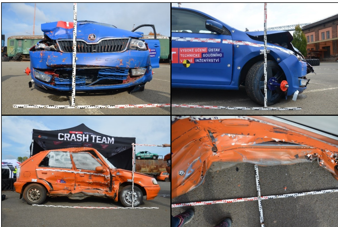
Obr. 12 Poškození vozidel po testu 1 [1]
