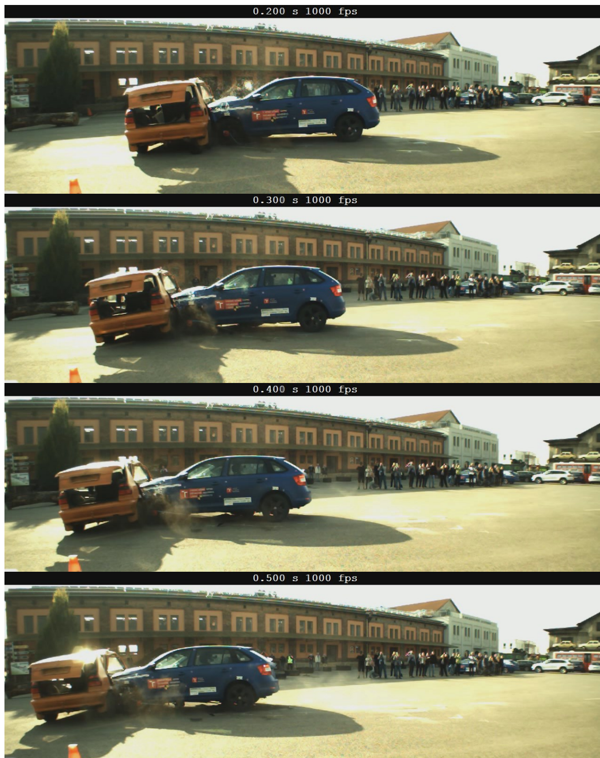
Obr. 14 Snímky z vysokorychlostní kamery při testu 1 (0,00 až 0,50 sekundy) [1]
