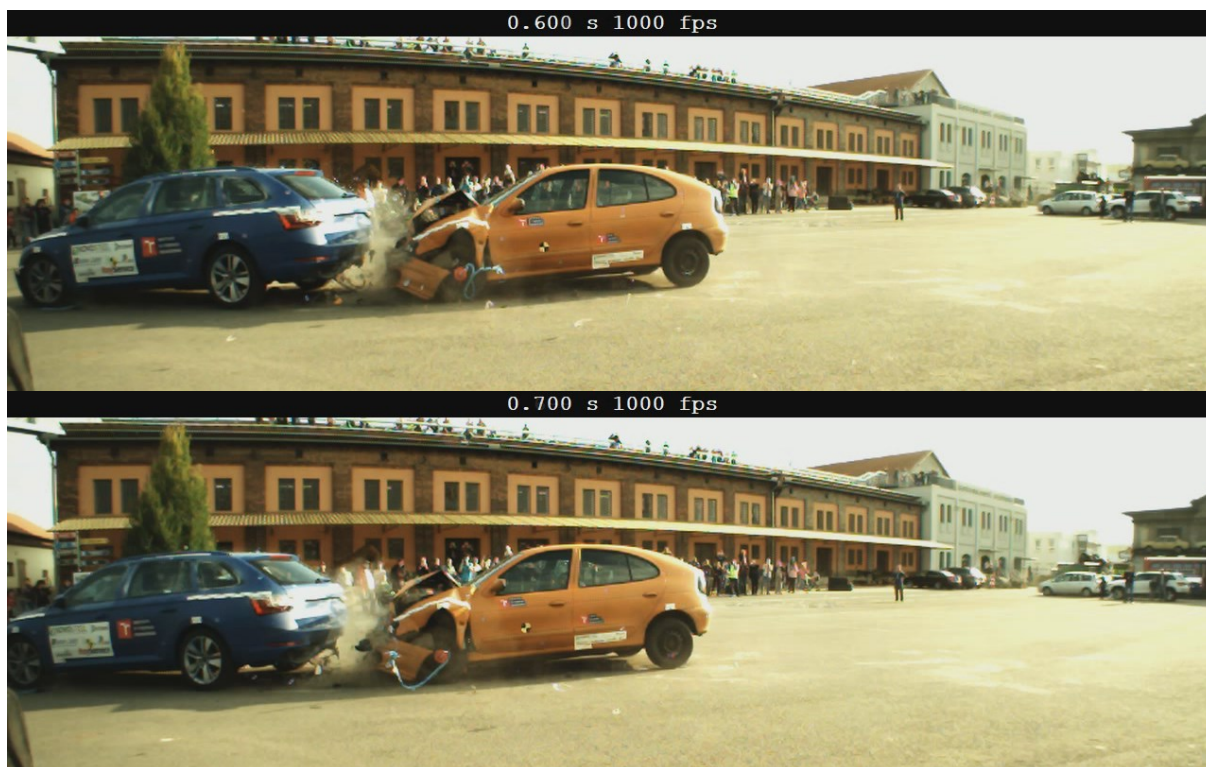
Obr. 29 Snímky z vysokorychlostní kamery při testu 4 (0,00 až 0,70 sekundy) [1]
