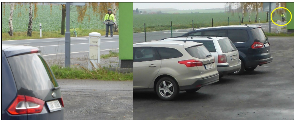
Obr. 4 Možnost spatření figurantky, tedy i místa, kde vozidlo Audi zachycené na videozáznamu vjíždí do záběru kamery, na vodící čáře 66 m ve středu jízdního pruhu 60 m před VBM
