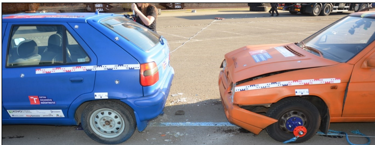
Obr. 8 Testovaná vozidla po první části uvítacího crashtestu [1]
