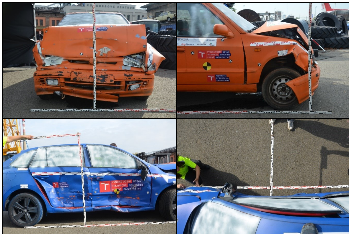
Obr. 17 Poškození vozidel po testu 2 [1]
