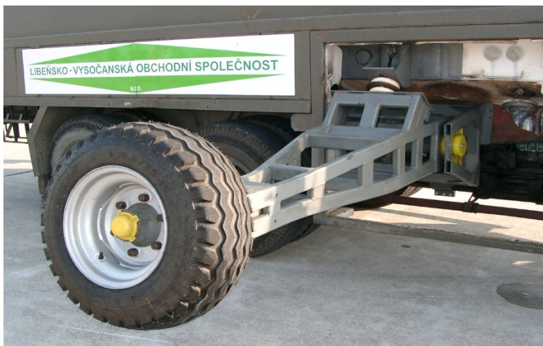
Obr. 3 Uchycení ramene na Tatra 148
