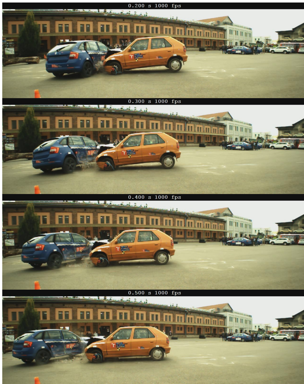
Obr. 19 Snímky z vysokorychlostní kamery při testu 2 (0,00 až 0,50 sekundy) [1]
