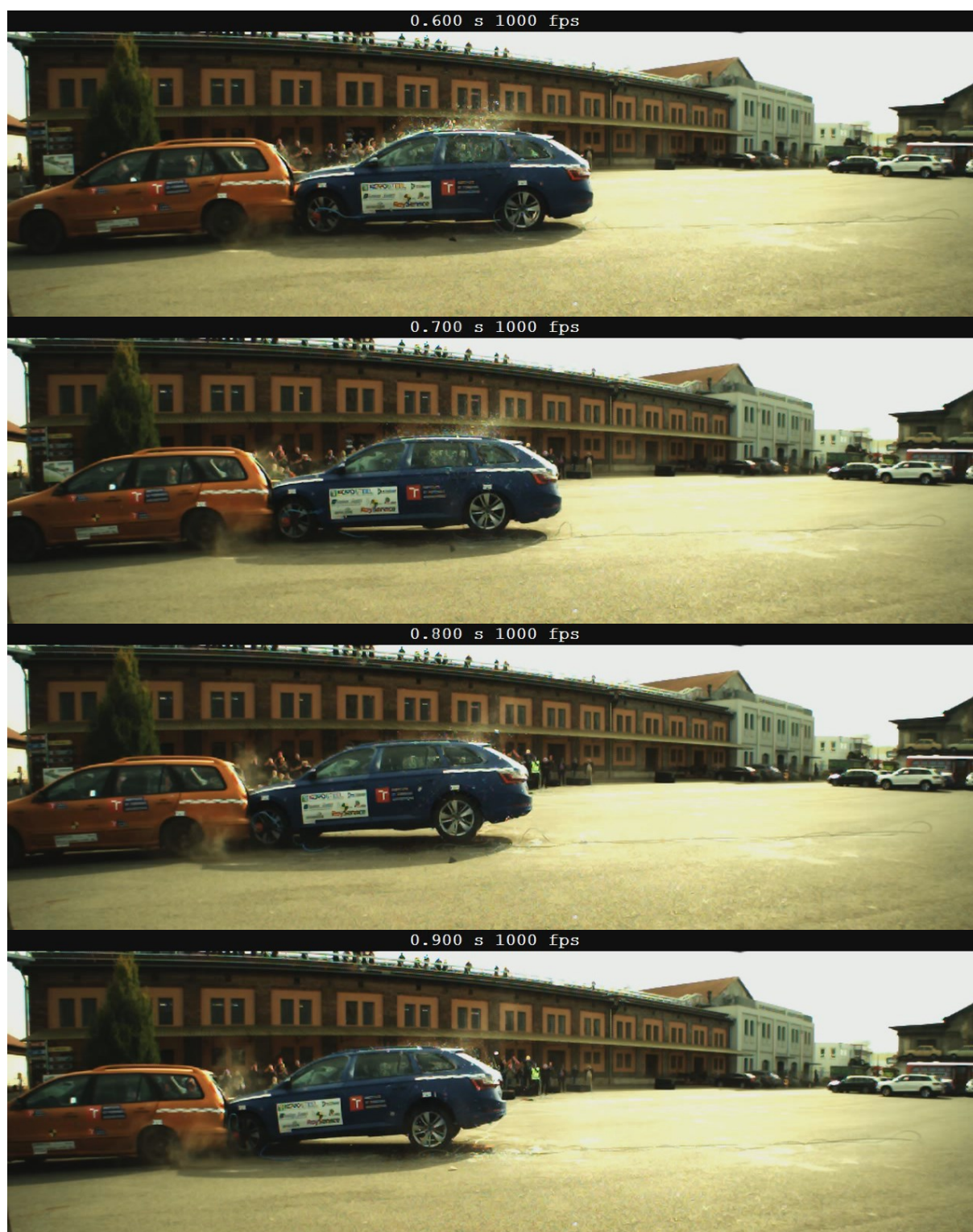
Obr. 24 Snímky z vysokorychlostní kamery při testu 3 (0,00 až 0,90 sekundy) [1]
